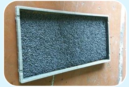
コーティング後は鉄の酸化で発熱するので、放熱させるために薄く広げます。
